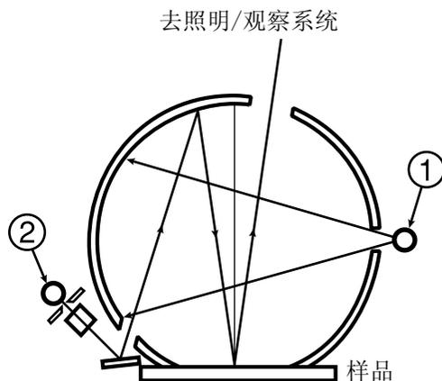
通过上述一次测量和计算就可以同时得到SCI和SCE数据，而不用传统方法中的要求的通过机械式的切换。
